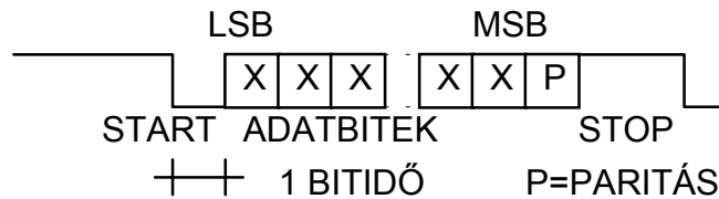
3.F ábra: Az aszinkron soros adatátvitel elve
